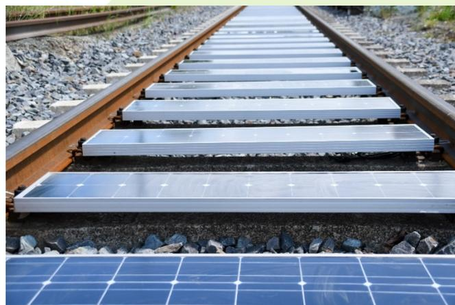
**Abbildung 9.9** Gleis-PV. Forschungsprojekte der Deutschen Bahn, Foto: [80]
